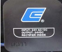
**SOLENOID PLUG (24VDC / 24VAC INPUT AND 24VDC OUTPUT)**
